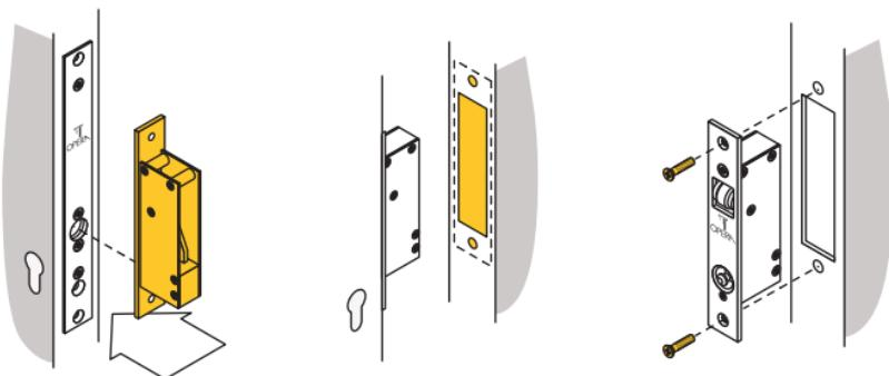
**Aggiungere la controserratura alla serratura e accostare l'anta** per individuare la posizione di installazione della controserratura sul telaio.
