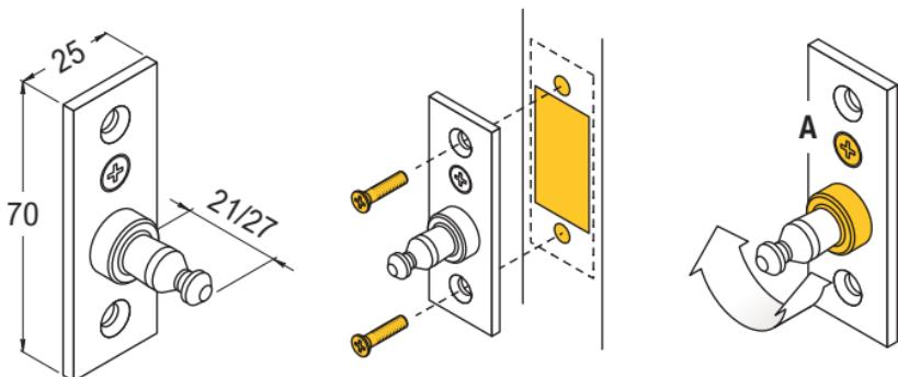
**Agganciare la contropiasta alla serratura e accostare l'anta** per individuare la posizione di installazione della contropiasta fissa sul telaio.
